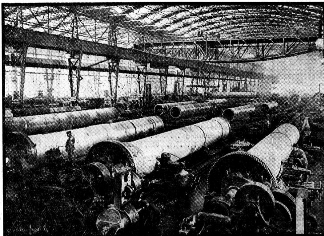
Krupp'sche nahtlose Kessel in der Bearbeitungswerkstatt.
