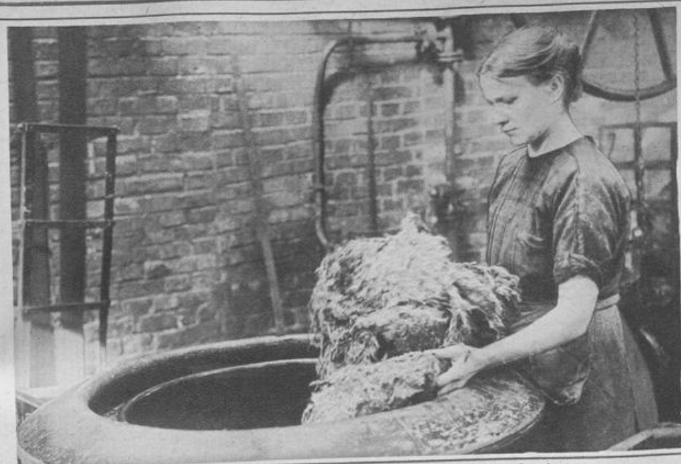
Die aufgewickelten Nesselfasern werden in die Centrifuge eingelegt
