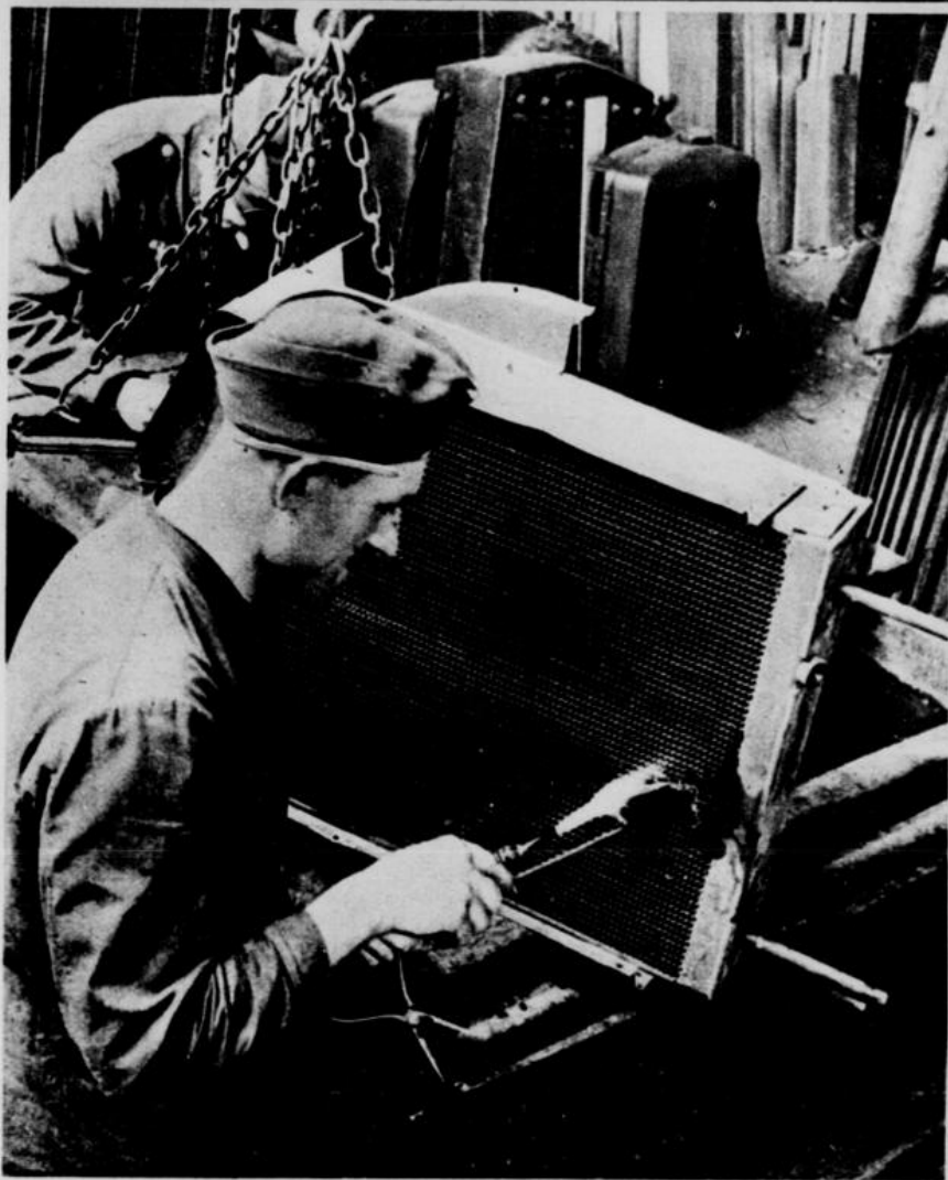
Sorgfältig werden beschädigte Kühler vom Klempner repariert
