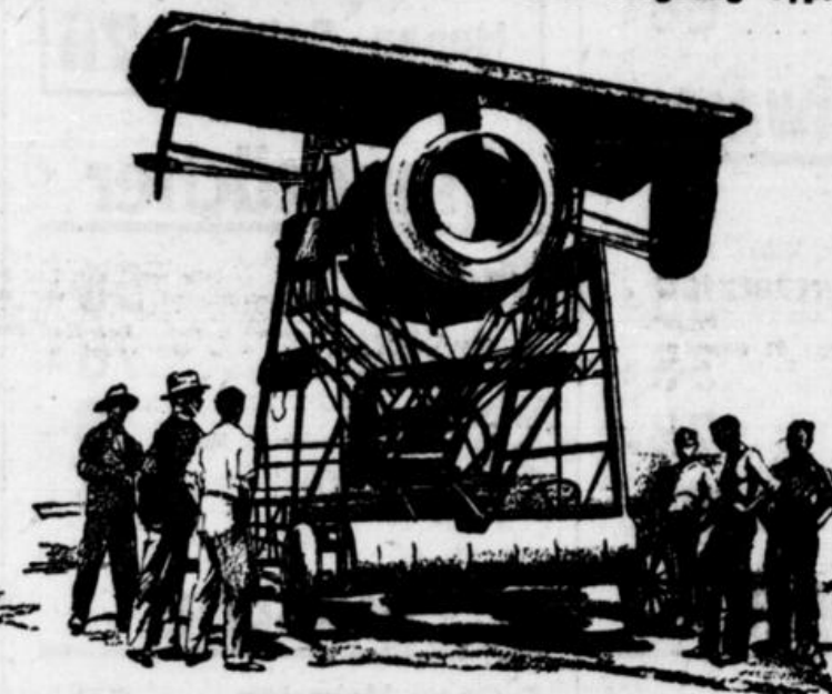
Der amerikanische Erfinder Paul Maiworm aus San Diego (Kalifornien) hat das hier abgebildete eigenartige Flugzeug konstruiert, das er den „fliegenden Wurm“ nennt. Die zur Fortbewegung erforderliche Kraft soll durch einen Zylinder erzeugt werden, der mit schraubengangartig angeordneten Flossen versehen ist.
