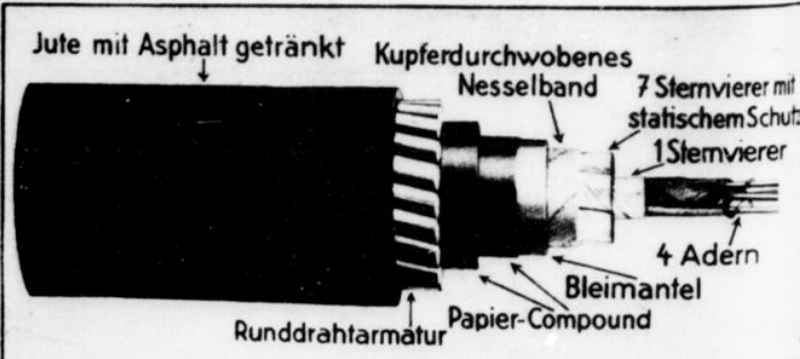
Aufbau des Kabels
