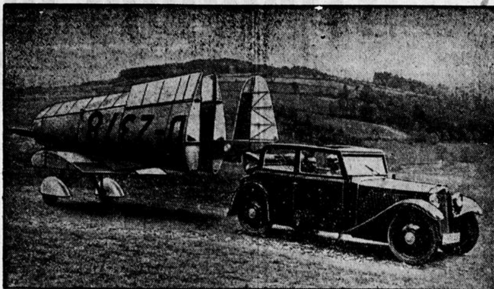
Transport des neuen Kleinflugzeugs mit zusammengeklappten Tragflächen.
