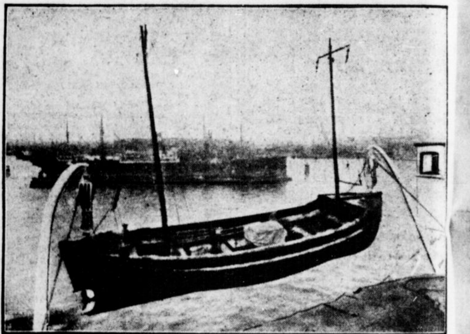
Die Hamburg-Amerika-Linie hat die Rettungsboote ihrer Passagierdampfer mit neuen Motoren und einer Radiosendestation ausgerüstet, um auf hoher See rasch Hilfe herbeizurufen zu können. Unser Bild zeigt ein Boot vom Dampfer „Albert Ballin“ mit der charakte- ristischen H. A. Antenne.
