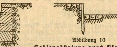
Abbildung 10. Sohlenabstufung durch Pfahlreihen
