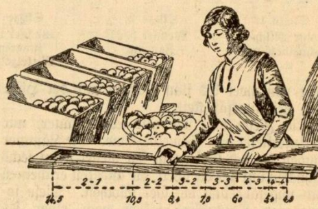
Abbildung 3 Apfellehre zum Sortieren nach der Größe
