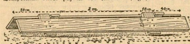
Abbildung 1. Bretter für Lüftungskanal.
