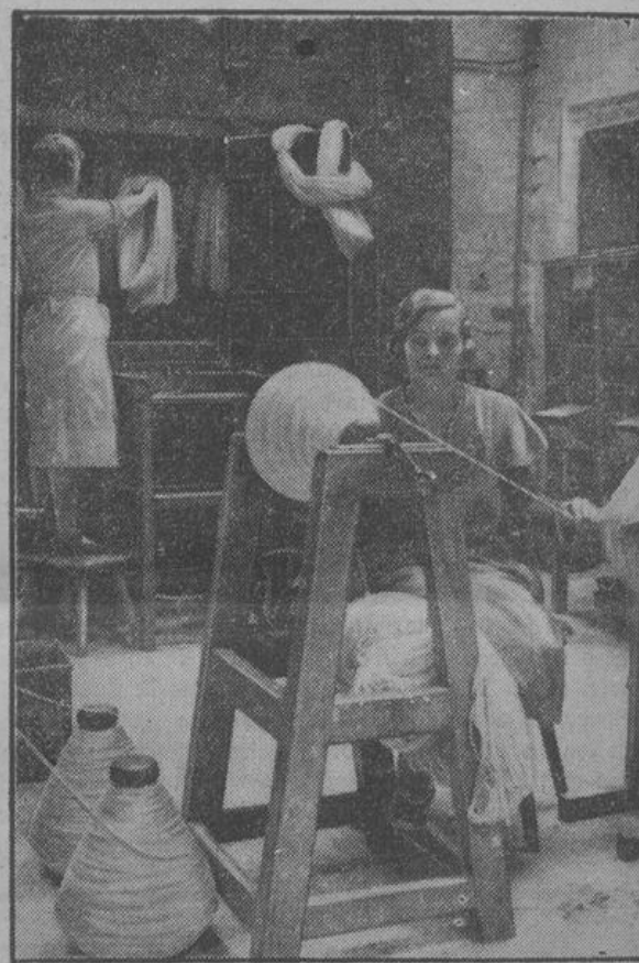
An einer spindelartigen Maschine werden die kilometerlangen Döchtschnüre aufgespult und dann in die Gießmaschine eingesetzt. Die Arbeiterin im Hintergrund des Bildes hängt Döchte zum Trocknen auf.
