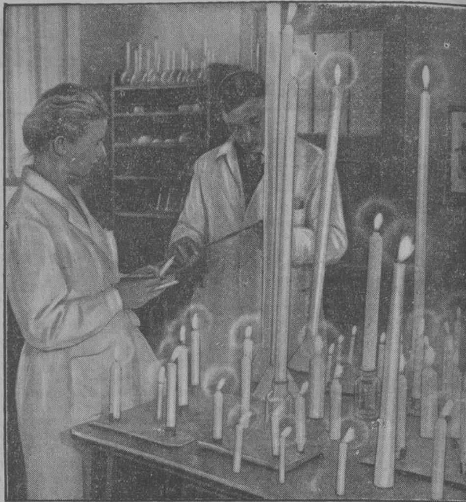
Der Tisch in der Kerzenprüferei. Von den einzelnen Güssen werden Kerzen, von der kleinsten Christbaumkerze bis zu dem großen Altarlicht, angezündet, um die Brennarart und damit die Güte des Gusses zu kontrollieren.
