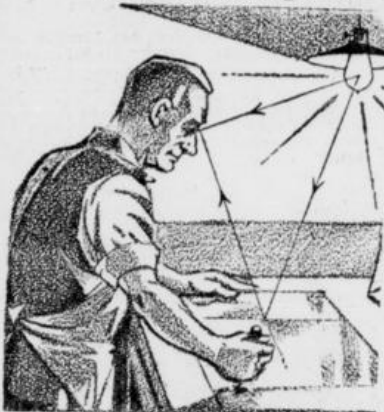
Blendung des Arbeitenden durch die ungenügend abgeschirmte Glühlampe und durch ihr Spiegelbild auf glänzender Arbeitsfläche.
