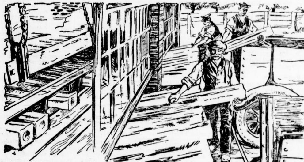
Die übliche Art der Eisfabrikation. Die kristallaren Blöcke gleiten aus der Maschine den Verladern zu.
